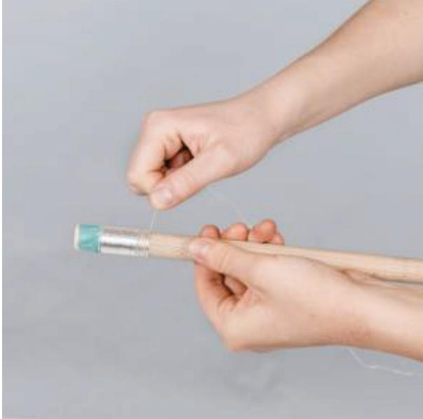
Wickelt den **Draht** auf den Stab – und zwar, indem ihr den Stab dreht und dabei den Draht führt. Wickelt den Draht eng: Lasst keinen Abstand zwischen den Wicklungen, die ihr richtig fest zieht. Umso besser flitzt später der Zug durch die Spule. Also wickelt... und wickelt... und wickelt... bis zum Ende des Drahtes.
