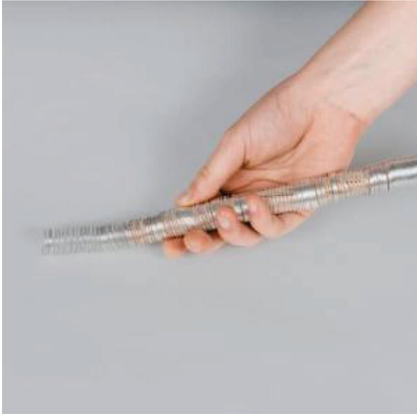
Habt ihr den Draht fertig aufgewickelt, drückt ihr bei der letzten Windung das Drahtende an den **Stab**. Lasst nun alles vorsichtig los, sodass sich die Spule entwirbeln kann. Löst den Klebestreifen vom Anfang der Spule und schiebt die Spule vorsichtig vom Stab. Sie darf sich dabei nicht verdrehen oder gequetscht werden.
