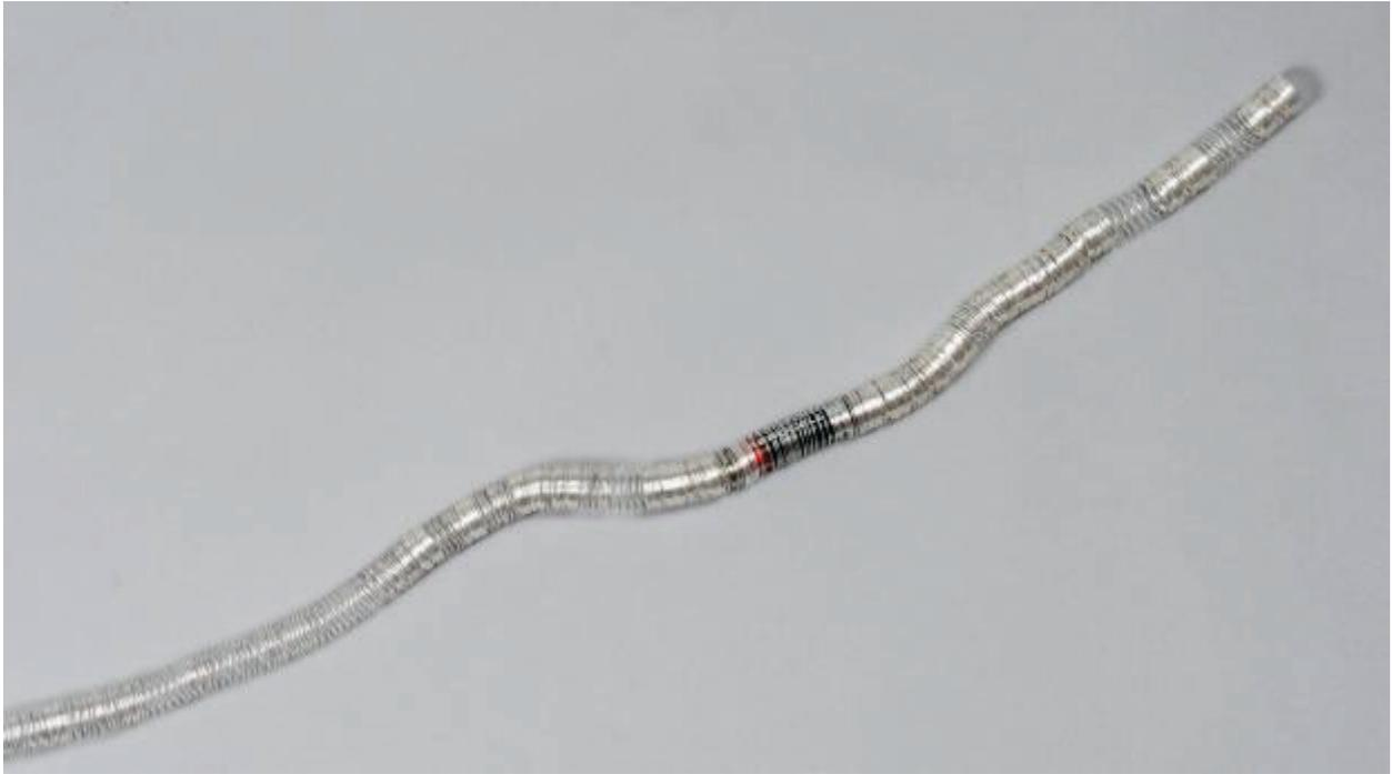
Schiebt den Batteriefliker an einem Ende in die Spule. Sofort setzt sich der Elektrozug in Bewegung und flitzt durch den **Spulentunnel**, dass es nur so rasselt... oder etwa nicht?
